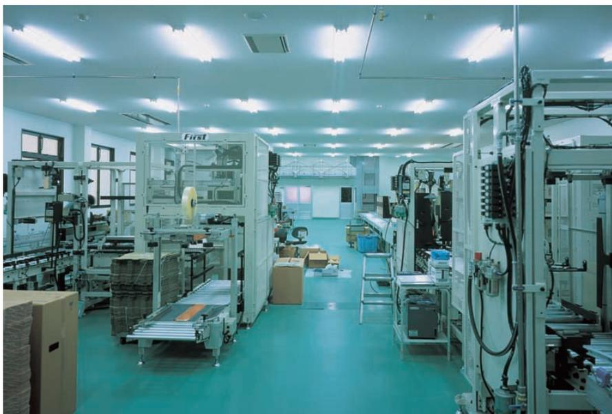
生産ラインの照明：Hf-Lcoフリータイプの32W2灯用逆富士形直付器具を整列配置している
