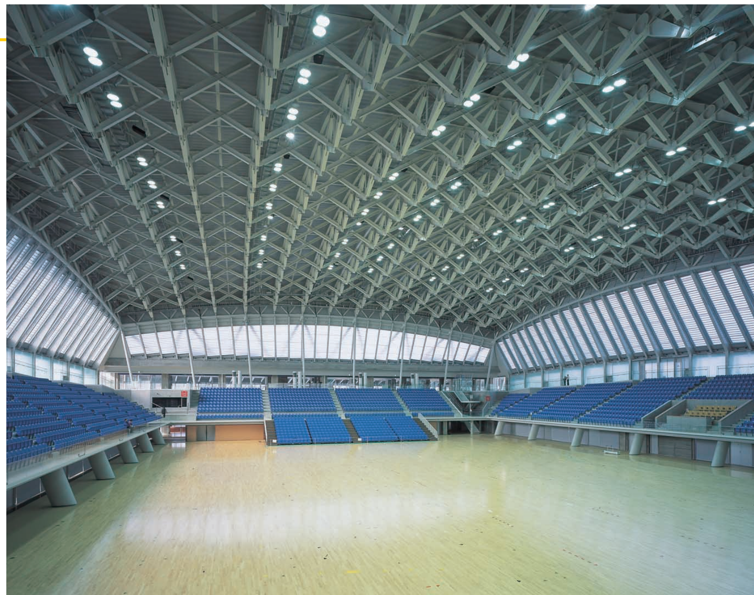
観客席5,371席(固定：3,391席、移動1,980：席)をもつメインアリーナ：屋内スポーツ向け器具(1kW高効率メタルハライドランプ)と照明可変器具(1.5kW高効率メタルハライドランプ)を設置。
