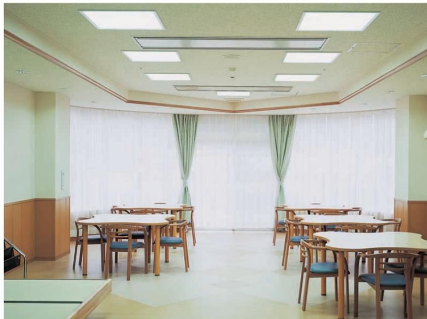
豊コーナーを設けて居住性を高めているダイニング・食堂の照明：55Wコンパクト形蛍光ランプ2灯用埋込スクエア器具(カバー付)を設置
