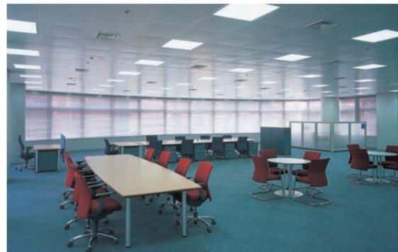
オフィススペース：天井モジュール600角に合わせた照明器具を開発。間仕切り変更に伴う照明器具などの移設が容易に行えコスト削減や期間短縮が図れる
