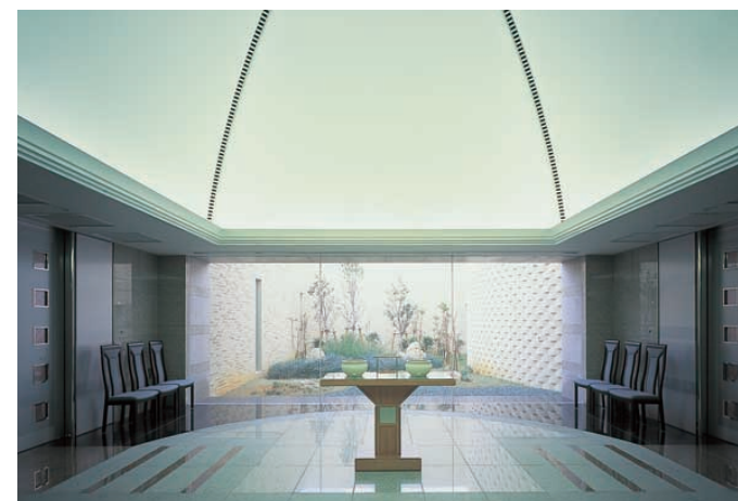
告别室の照明：Hf蛍光ランプ間接照明器具を採用し、光庭から昼光を取り入れて厳粛な雰囲気を漂わせている
