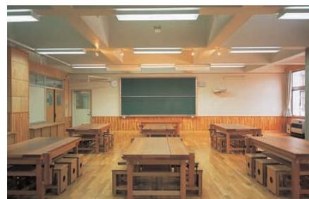
図工教室の照明：普通教室と同様の器具と随所に75Wハロゲンランプスポットライトを配置
