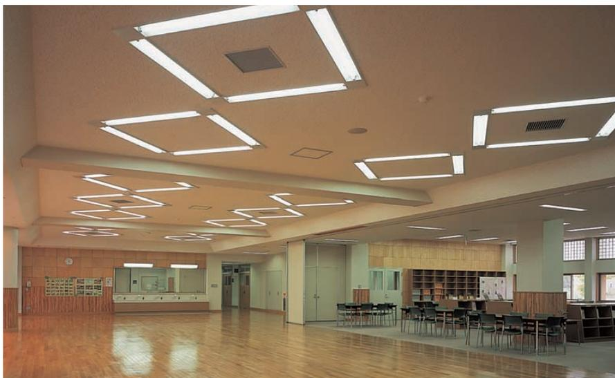
多目的スペースの照明：32WHf蛍光ランプ1灯用埋込器具を菱形の連続パターン配置とし、60Wミニクリプトンランプダウンライトを下がり天井に設置
