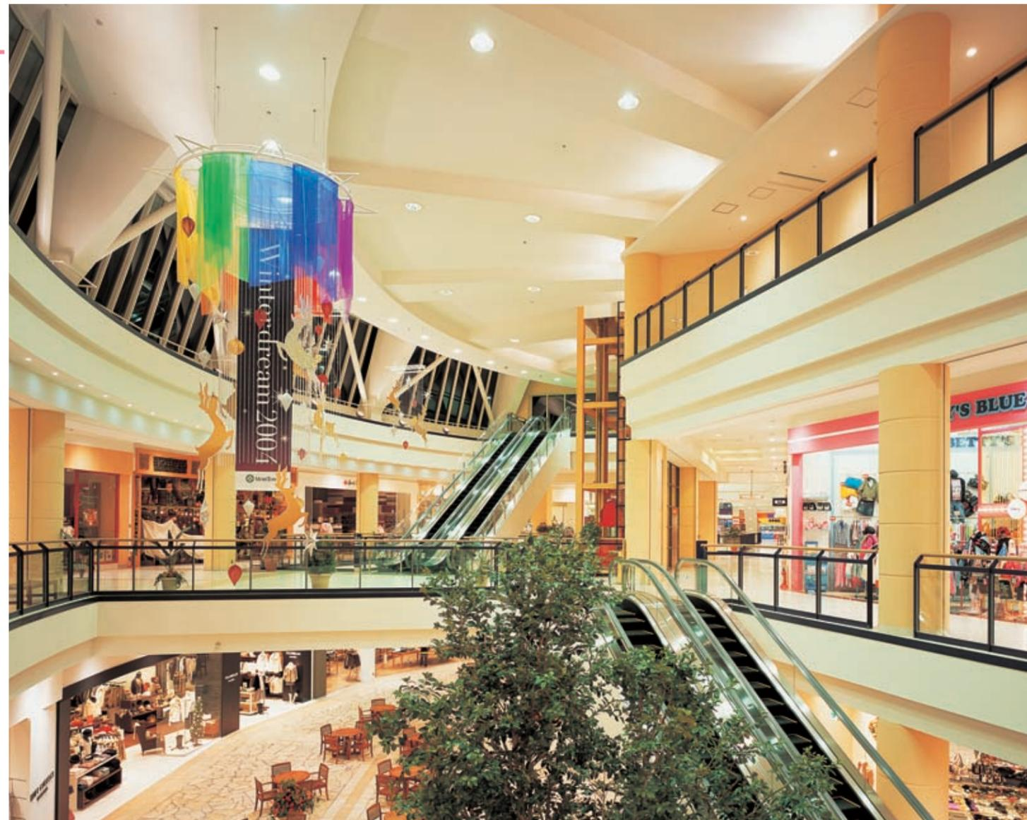
太陽の広場(吹き抜け部)の照明(2階共有通路から望む)：400Wメタルハライドランプ昇降装置付ダウンライトを使用して明るさを確保。夜間は150Wセラミックメタルハライドランプ投光器でライトアップしている
