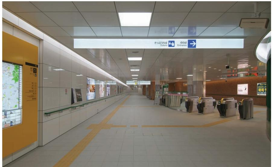
薬院大通駅 コンコース：建築と一体化した壁面照明を配置し、空間の広がり感を演出している。また、利用者のスムーズな誘導を助けるため、天井部には出入口から続く動線に沿って600角モジュールのスクエア器具を規則的に配置している
