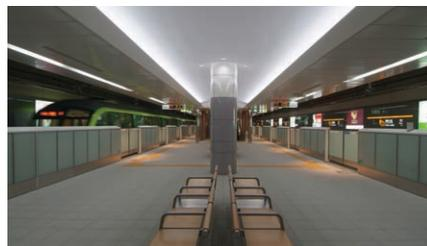
薬院大通駅 ホーム：軌道に沿ったHf32Wによるライン照明の他、ドア前にはその位置を解りやすくするためCDM35Wダウンライトを配置。ラウンド天井に間接照明と柱周りにダウンライトを配置している。
