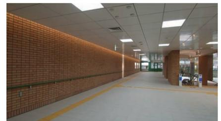
薬院大通駅 個性化壁面：各駅に設定されている個性化壁面を、その素材・色彩に合わせた光色と演色性の高いランプを選定し、各駅の個性を表現している
