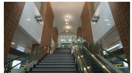
薬院大通駅 階段・エスカレーター：階段位置を解りやすくし、かつ昇降時の開放的な空間演出のため、ラウンド天井を上下配光のペンダントとスポットライトにより照らし上げている
