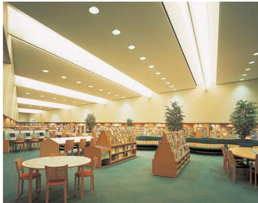
新聞・雑誌コーナーより一般開架コーナーを望む：FHP105Wトラフを内蔵したトップライトとEB250Wバンクライトを採用した吹き抜け天井照明
