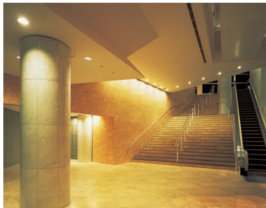
エントランスホールの照明：電球色のコンパクト形蛍光灯ダウンライトにより大理石仕様の壁、床、階段を明るく照らしながらグレード感を高めている
