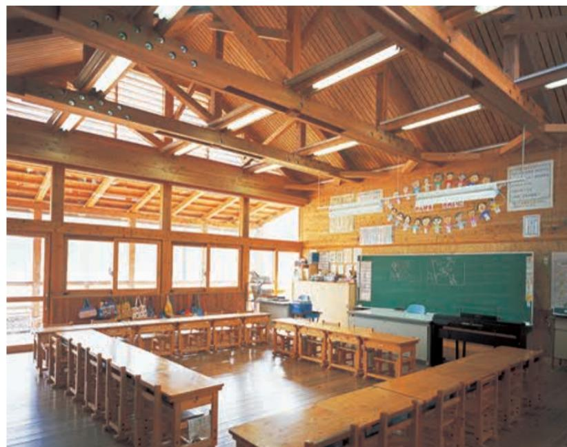
小学校低学年の教室：照明器具は合わせ梁に組み込み設置。器具を目立たなくしつつ、学習環境に適切な明るさを形成
