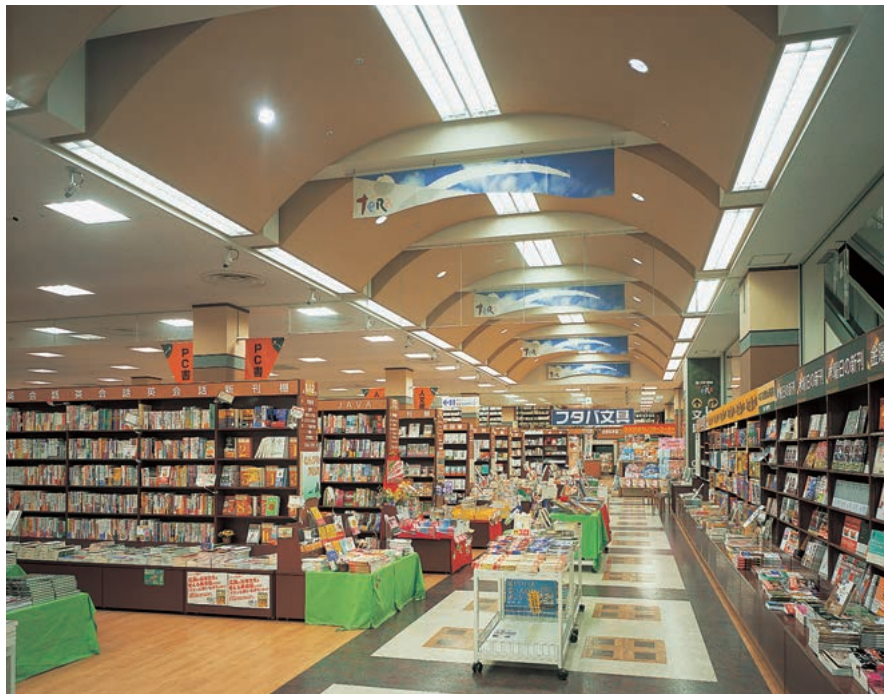
メイン通路の照明：110W蛍光ランプ2灯用埋込器具（バツフル付）を採用し、“流れる光”を演出
