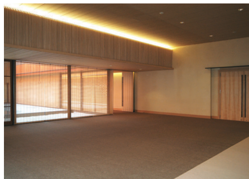
池を東側方向へ見通す迎賓館内観：天井には32Wコンパクト形蛍光灯ダウンライトを、間接照明には32WHf蛍光灯を採用
