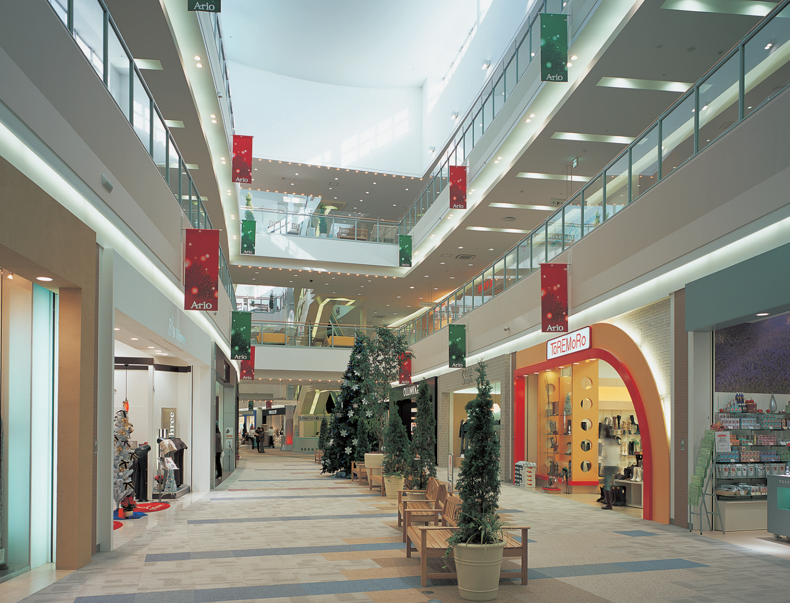
1階から望むアリオモールの照明：カーブに沿って間接照明が配され、パターンを変えた通路の照明、壁面ブラケット、投光器による天井のライトアップなど、新しい照明手法を随所に採用
