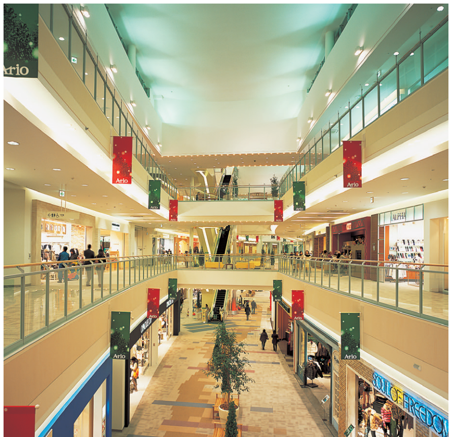
アリオモールの照明：メタルハイドランプ投光器のライトアップで3層モールの立体感を強調。2階天井レベルからはユニバーサルダウンライトで1階床面を照射
