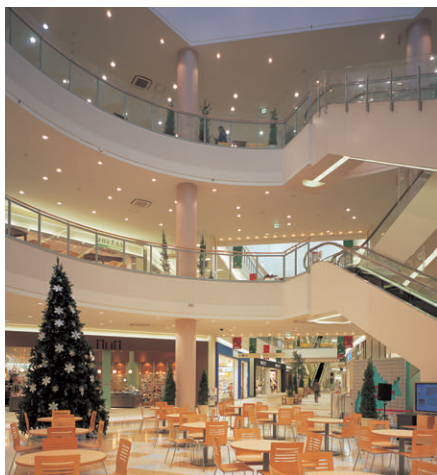
ハーベストコートの照明：円形状に美しく配置されたセラミックメタルハライドランプダウンライト
