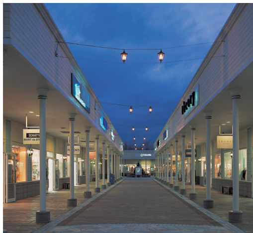
屋外のモール回廊：壁面ブラケットと同デザインの吊下器具を配置、動きのある光を演出
