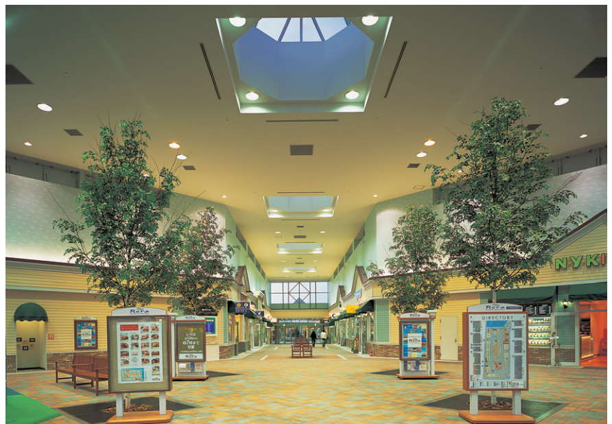
柔らかな陽ざしが差し込むガラス張りのアトリウム：メタルハライドランプとナトリウムランプの混光照明を採用
