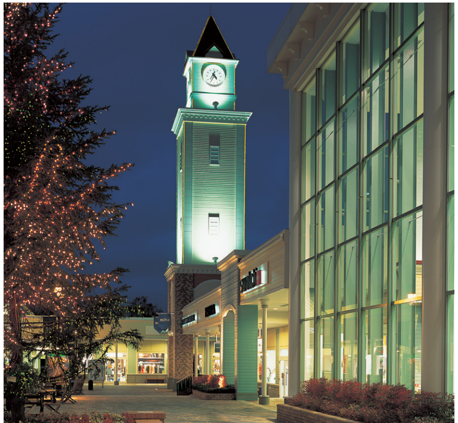
アトリウムを右にライトアップされた時計台タワーを望む：タワーの輪郭に沿って設置されたLEDチューブライトとメタルハライドランプ投光器で白くライトアップ。シンボルタワーとしての存在感を表現
