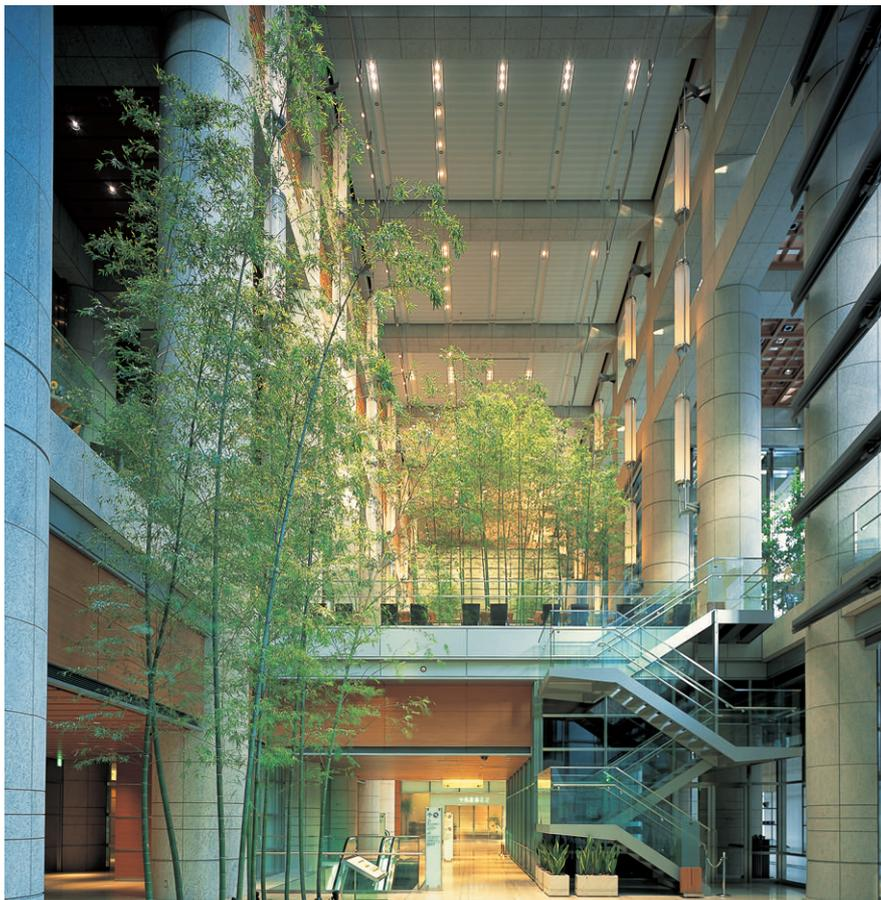
アトリウム、エントランスホールの照明(1)：高演色でグレアを感じさせないダウンライトと投光器の照明により、エレガントで開放的、洗練された印象を与える
