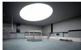
展示ロビーの照明：円形状のトップライト(下面アクリルカバー付)内部にHf蛍光ランプ特注調光形トラフを設置
