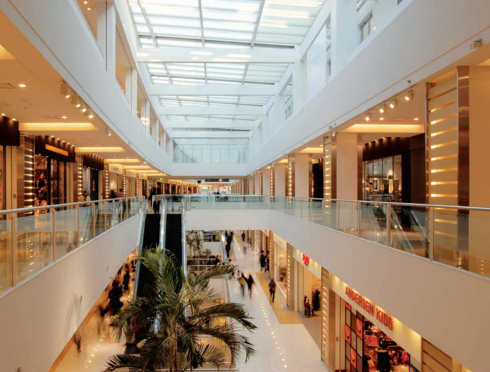
インナーモールの照明：トップライトからの自然光を取り入れ、モールの通路に設けたライン照明、HIDユニバーサルダウンライトなどにより吹抜け部分にも光が差し込むように配置
