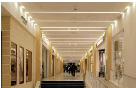
1階通路フラット天井照明：スリット内に蛍光灯ランプを直線に配置。両サイドに蛍光灯ダウンライト(FHT42W)を設け光のアクセントを出している
