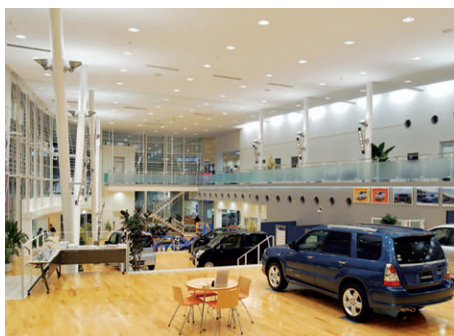
上段付近から下段方向を望む：天井照明のほか、外光との光バランスを意識したウォールウォッシュ照明を設置
