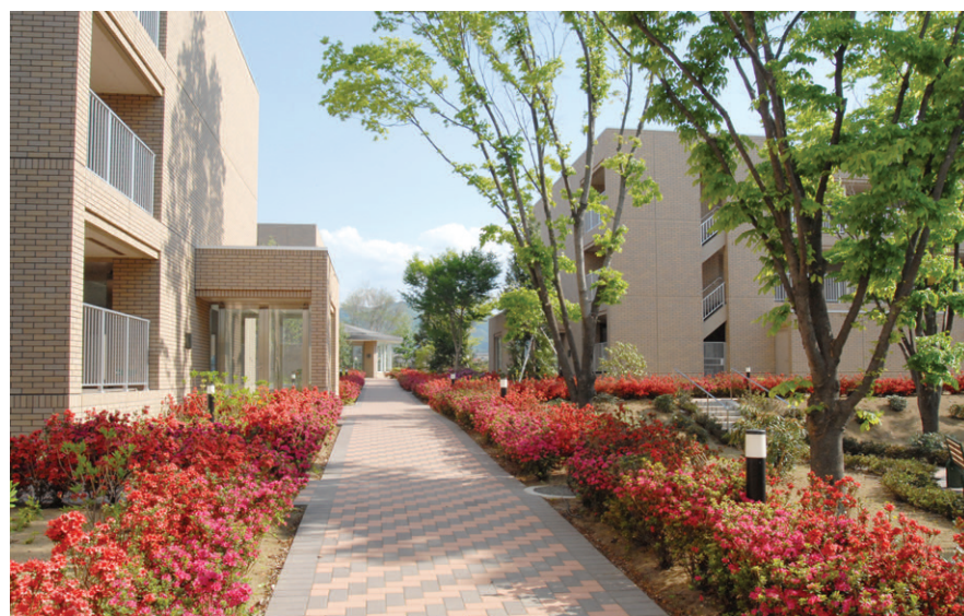
アゼリアが咲く中庭は、コルゲートケーブルで送り配線された電球形蛍光灯13W形ガーデンライトを10m間隔で配置
