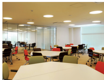
研究室とガラス間仕切りされた教室の照明：研究室と同様の丸形埋込器具カバー付を採用
