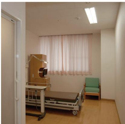
1床病室の照明 ベースに電球色の2灯用埋込器具(FHF32W)を、ベッド灯にはアーム式(FML13W)を使用
