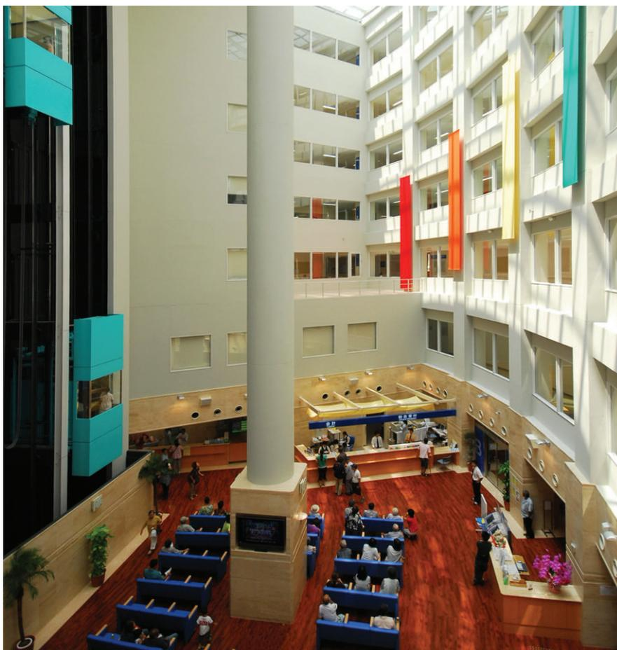
7層吹抜けの1階総合受付・待合室の照明 緩い曲面をもつ内壁にCDM150W小形投光器（ピクシア）を設置し、下方照射で必要照度を確保しつつ、さわやかさを演出
