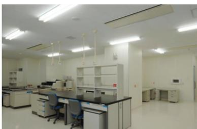
採血・臨床検査室の照明 2灯用逆富士形器具(FHF32W)で高照度を確保
