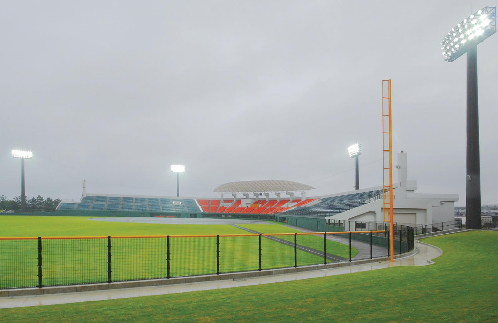
レフト側外野席よりホームベース方向を望む ナイター照明全点灯時でバッテリー間1500lx、内野1000lx、外野800lxを得ている
