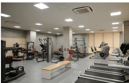
トレーニングルーム FHP32W4灯用下面開放形スクエア器具の調光タイプを採用したトレーニングルーム
