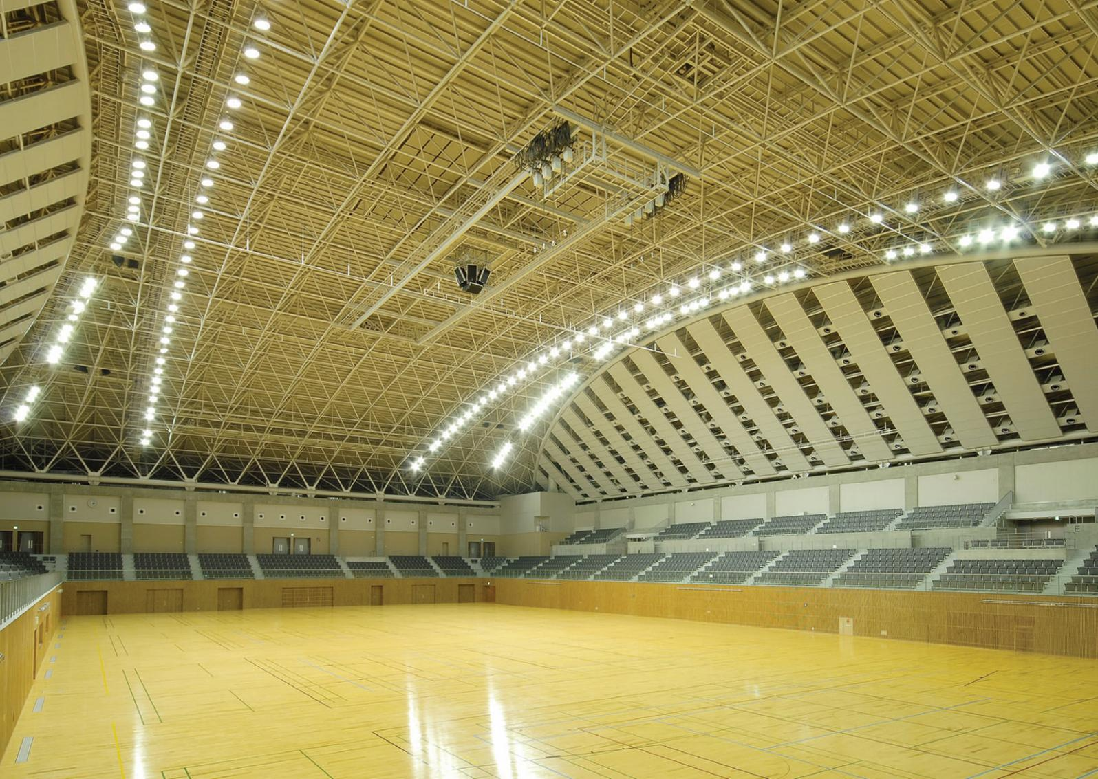
アリーナ全景(全点灯時) センターコート上で平均水平面照度2500lx、東西方向の平均鉛直面照度を1000lxに設定。公式競技レベルでTV中継対応の照度が確保されている
