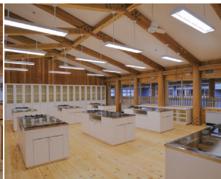
2階調理教室の照明 グレアカットのスクールソフトパイプ吊器具を採用
