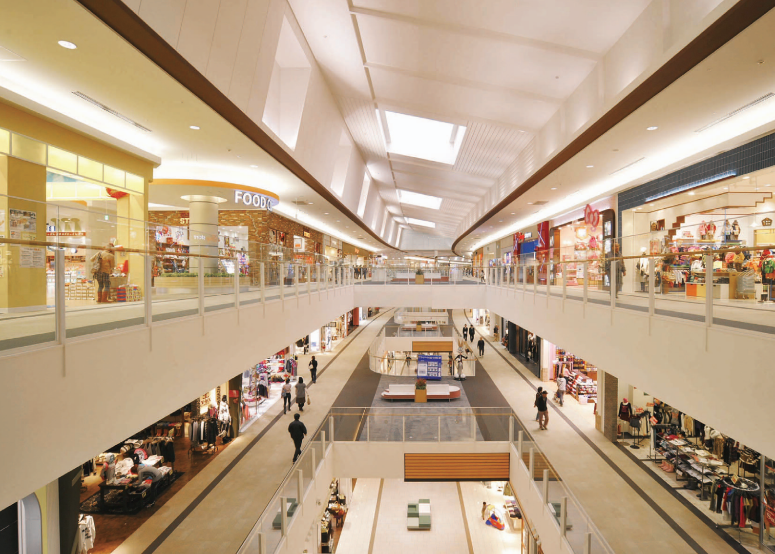
ショッピング通路にネオセラダウンライトで快適感を、動線に沿って間接照明で広がり感を、さらにトップライト内にネオセラアップライトを配置。柔らかな光で全体を包み込んでいる
