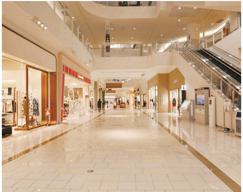
イオンモール専門店街1階の照明 100Wネオセラダウンライトをメインに採用し、3台1組の70Wネオセラスポットライトで分布のメリハリをつけ賑わいを演出
