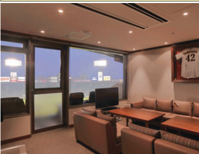
個室タイプの観覧席「ロイヤルスイート」の35Wローボルトハロゲンダウンライト
