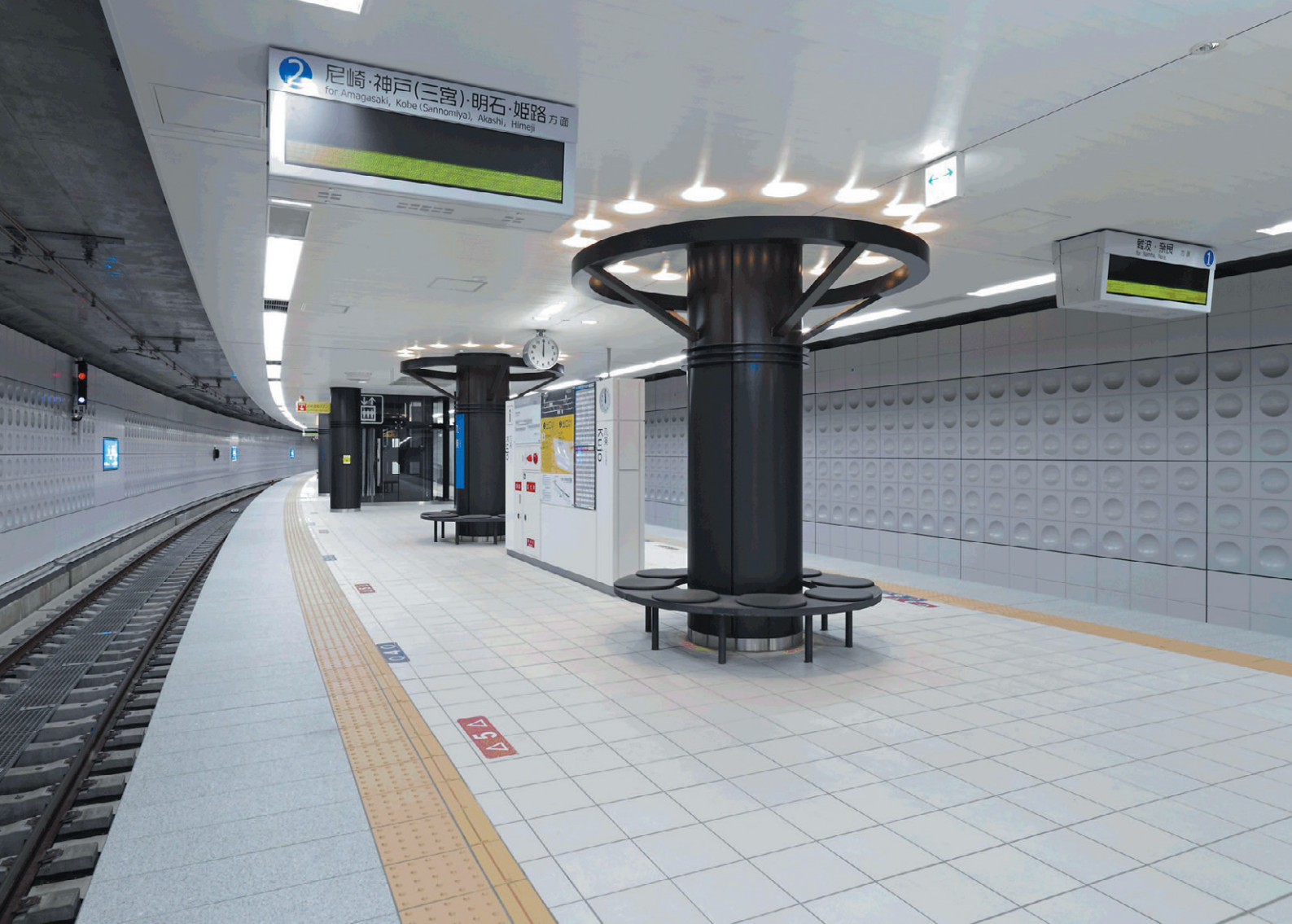
プラットフォーム中央の照明 柱上部のモニュメントにLED照明を組み込み、上方照射で乗降客の目を楽ませているアクセント照明
