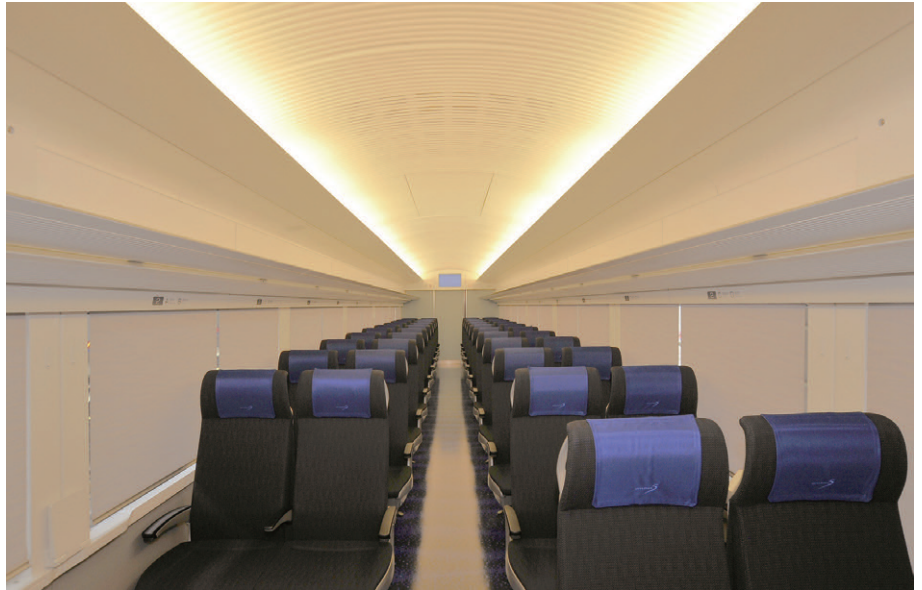
新型スカイライナーの客室内の照明 天井両側に採用されたFLR40Wによる間接照明。旅への期待感、贅沢感、疲れを癒す安らぎの空間を演出
