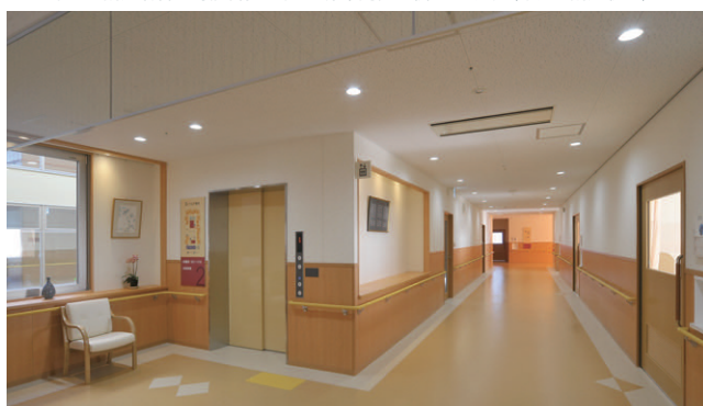
歩行訓練を考慮した幅広い療養室の廊下 LEDダウンライト白色相当を壁に沿って配置(写真は調光状態)
