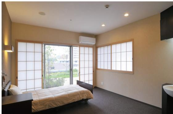
個室Bタイプの照明 LED電球一般形ダウンライトはベッドを囲む形で3台を配置
