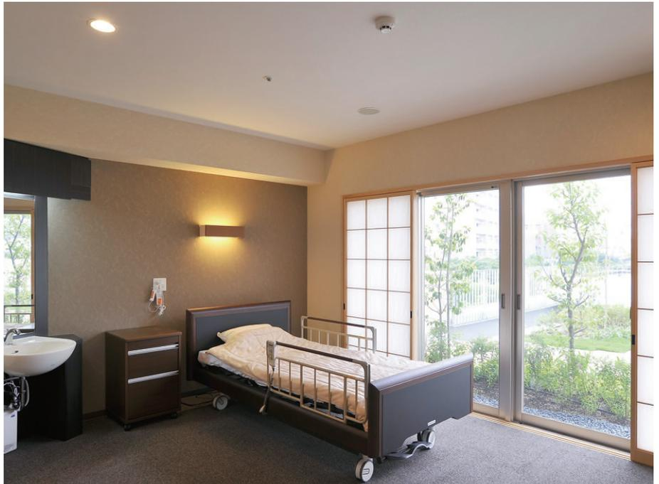
個室Aタイプの照明 障子を使用した和洋折衷の個室で、ベース照明にはLED電球一般形ダウンライトを採用し、枕元灯は上・下配光形の蛍光灯ブラケット
