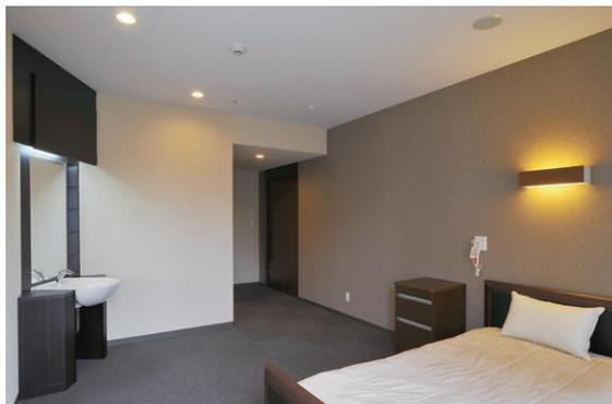
個室Cタイプの照明 LED電球ダウンライトとブラケットはすべて電球色相当を用い、家庭的な雰囲気を出し
