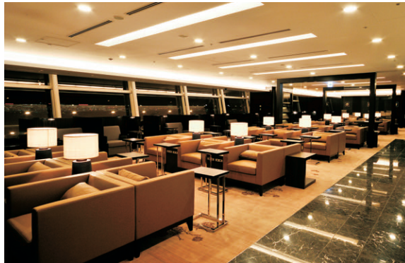
ファーストクラスラウンジの照明(2) 窓際にはハロゲンランプダウンライトを配し、ガラスへの映り込みが夜景の邪魔にならないように配慮
