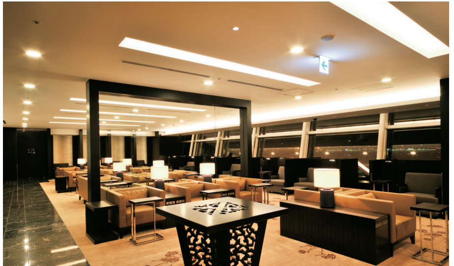
ファーストクラスラウンジの照明(1) 天井を掘上げたラインと窓の上の間接光、ライン間のダウンライトにより、上質でゆっくりとくつろげる空間を演出
