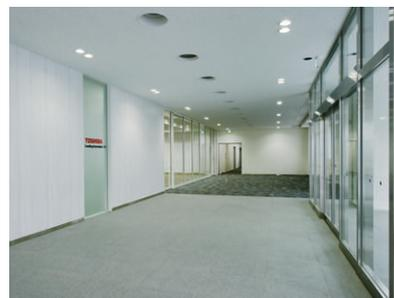
エントランスホールの照明は人感センサーと明るさセンサーで減光制御
