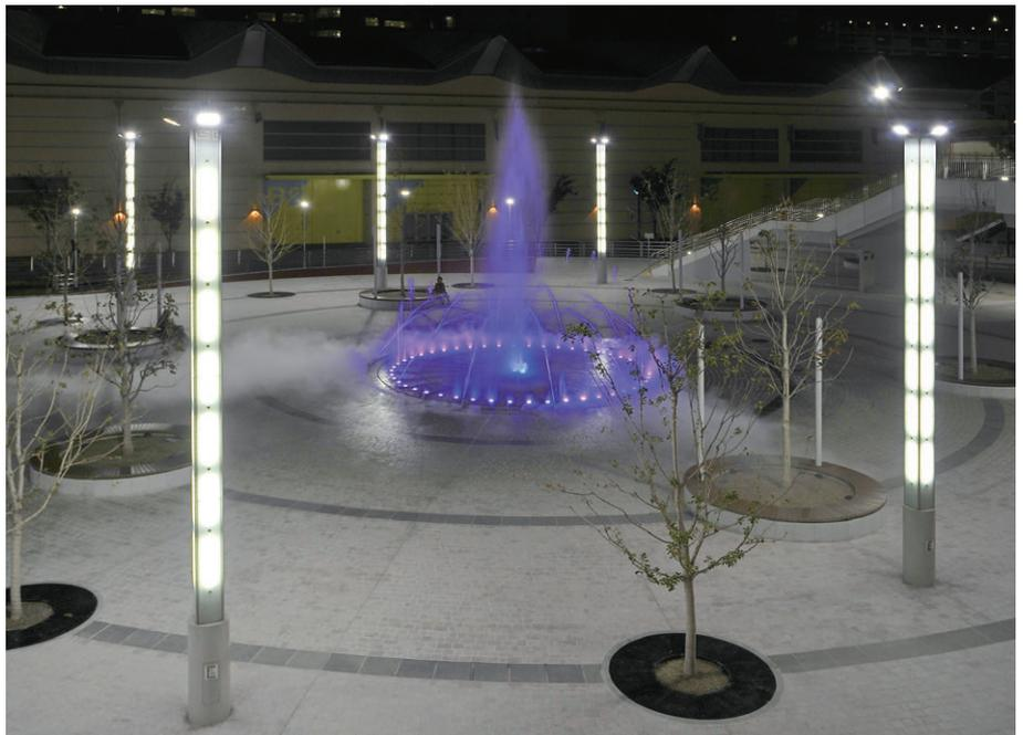
親水広場の照明 8m高さのスクエアポールの4面にLEDライン光を埋込みポール全体を発光。頂部にはLED投光器を配備
