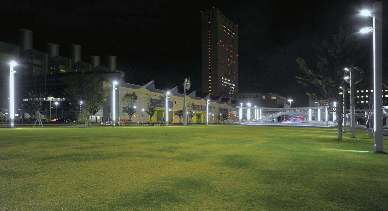
多目的芝生広場の照明 8m四角ポールの1面にLEDライン光を内蔵して面的照明とし、頂部には中・遠距離の照度を確保するLED投光器を配備
