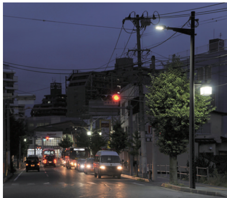
交差点付近にはアーム付デザインポールにLED車道灯とLED歩道灯の組み合わせを配備
