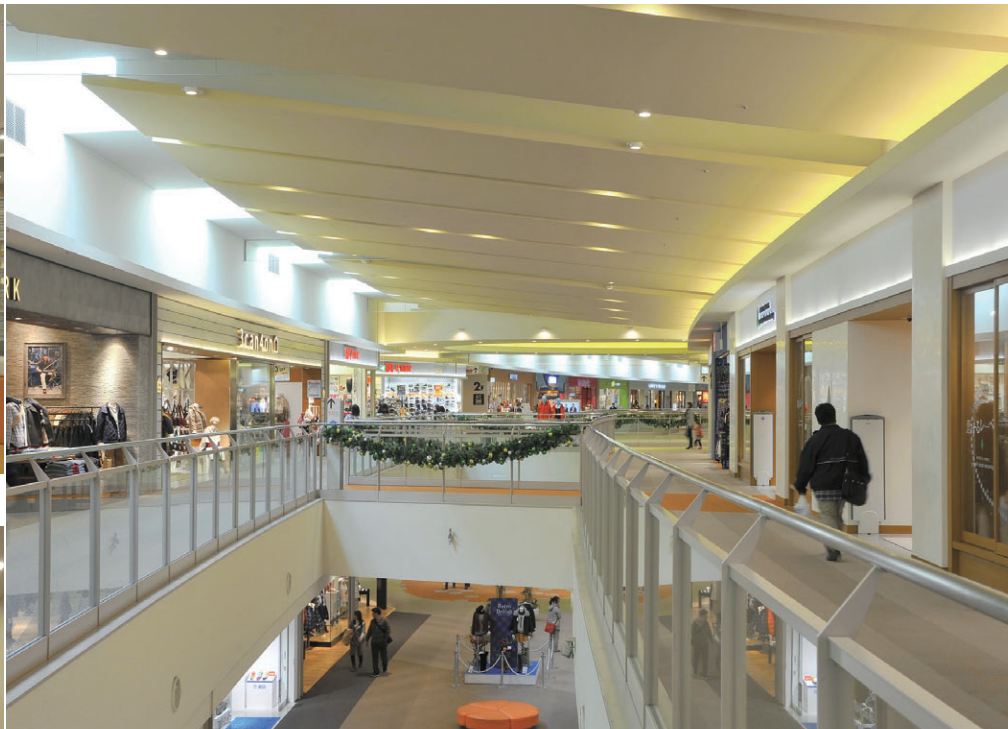
2階モール通路の照明 トップライトからの自然光と蛍光灯の間接照明、LEDダウンライトの光が調和し、明るい空間を演出
