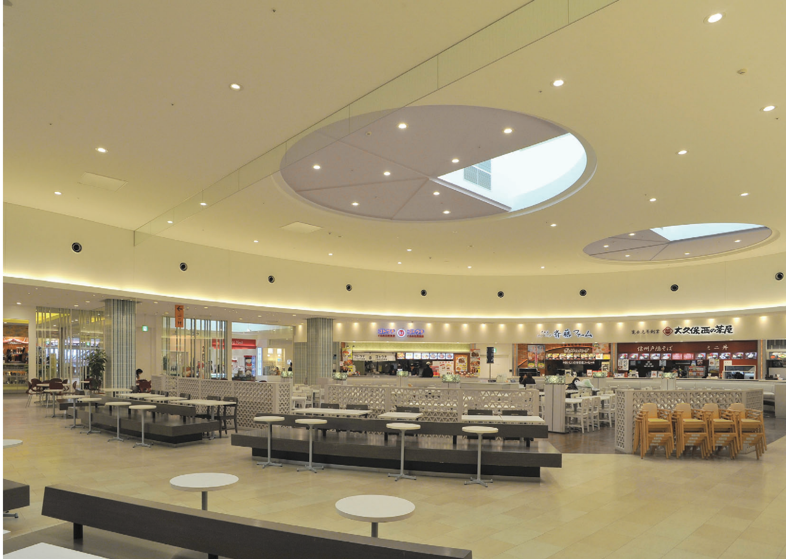
フードコートの照明 蛍光灯の間接照明とLEDダウンライトにより、明るく楽しい雰囲気を演出
