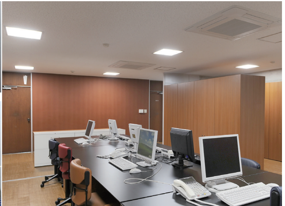
経理事務室はLEDベースライト埋込形スクエアタイプを用いて落ち着いた空間を演出
