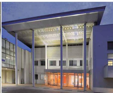
ピロティの2階天井ルーバーをLED小形投光器により照射
