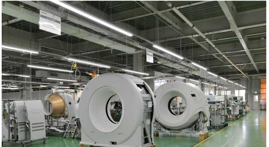
CTシステム製造ラインの照明 既設の110W蛍光灯器具から一体形LEDベースライトスリムタイプに更新し2,450mmの高さに設置(通路は2,800mm)
