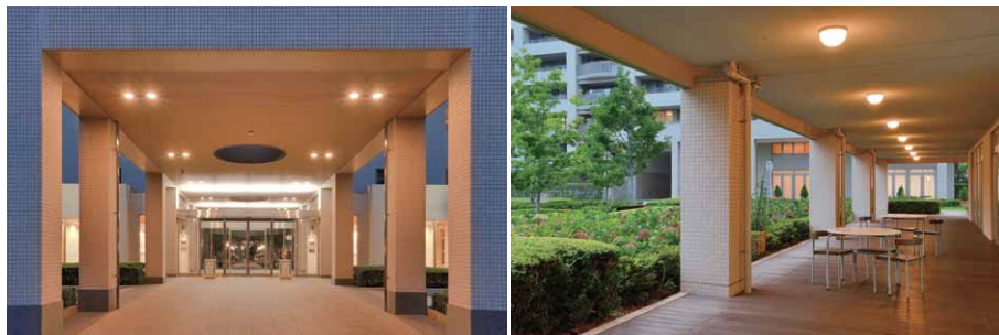
LEDダウンライトと直管形LEDベースライトによる間接照明を組み合わせたエントランスの光空間 ウッドデッキに安らぎを与える電球色のLEDシーリングライト
