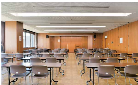
掘り上げ天井内の蛍光灯トラフからLEDトラフに更新した一般会議室
