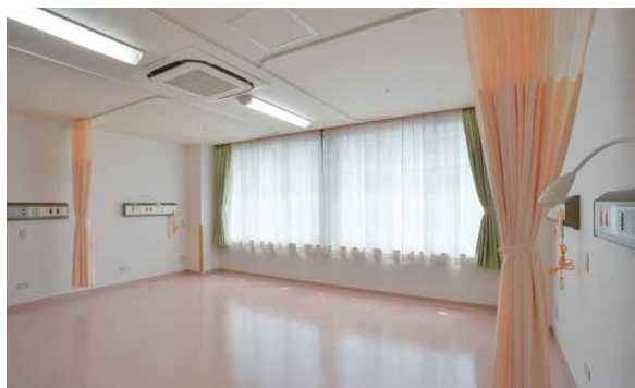
4床病室の照明 ベッドライトはLEDベッド灯を採用
