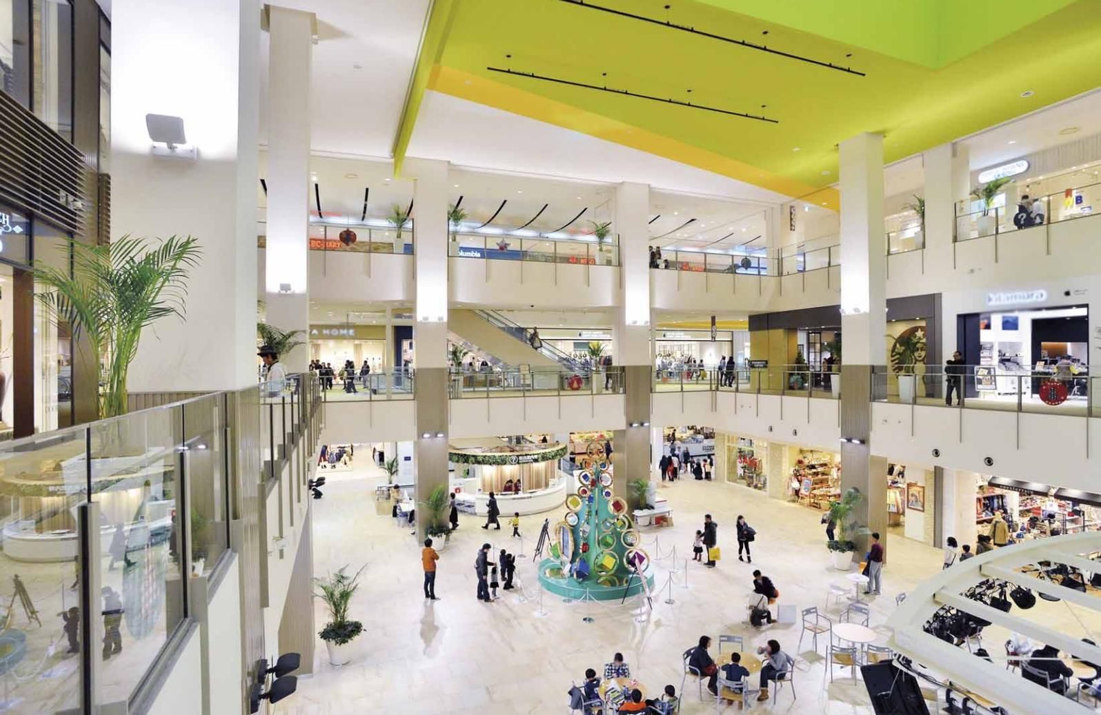
センターコート照明 東西南北をつなぐアンカースペース。13m超の高天井のため、メンテナンスに配慮して照明器具は一切設置せず、モール側照明と店舗地明りにより床面平均照度400~500ルクスを確保。柱・天井に対する演出照明により明るさ感を高め、施設の中心的存在感を創出
