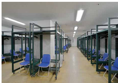
直管形LEDベースライト(高出力タイプ)で明るく落ち着いた空間とした選手控室
