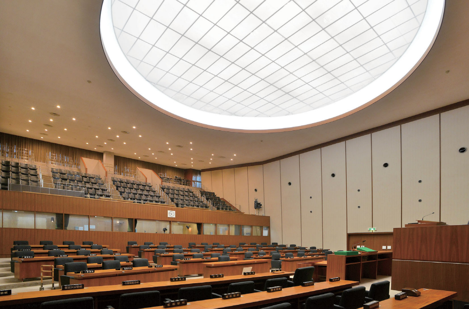
議場席の真上に設けられている円形コブには、その内部にLED高天井器具を設置して議場を照射
