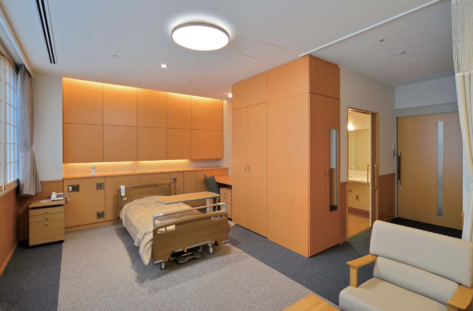
個室の照明はLEDシーリングライト、LED間接照明、LEDベッド灯、LED処置灯など多彩な器具を採用
