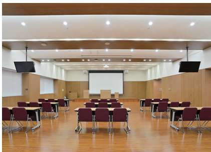
LEDダウンライトとLED間接照明による大会議室の照明
