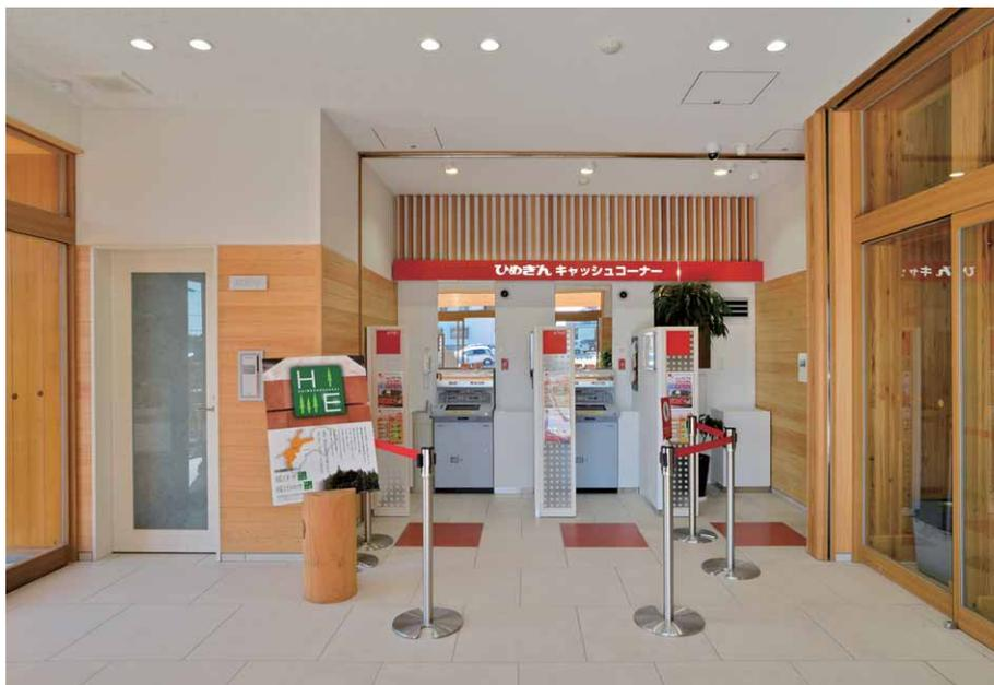
遮光角15°のLEDライトエンジンダウンライトを採用し、十分な明るさを確保しつつ、眩しさを抑制したATMコーナー
