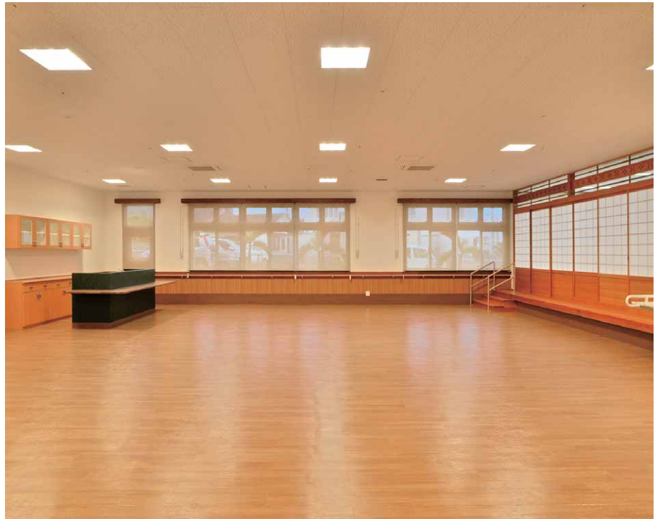
和室静養室付デイサービス（食堂兼回復訓練室）は光に方向性のない電球色のLEDスクエア器具を均等配置
