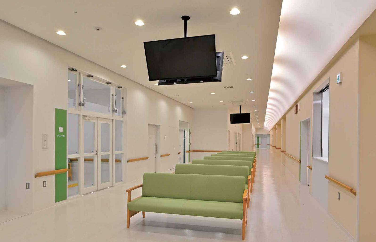
外来待合室兼廊下は待合部分の天井フラット部に電球色のLED一体形ダウンライトを、廊下部分のアール天井部に昼白色のTENQOOシリーズトラフを設置し、空間の光色の違いにより用途を明確に分離
